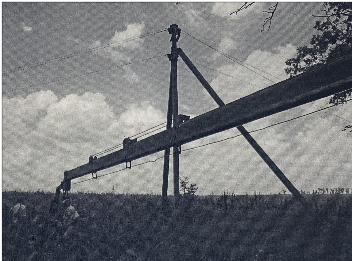
Стрела автовышки грузового автомобиля, подведённая к ЛЭП
