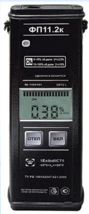
Газоанализатор ФП11.2к для измерений объемной доли газа метан в воздухе и выдачи звуковой и световой сигнализации при превышении установленных порогов значений объемной доли газа. Диапазон измерения от 0-2.5%, порог срабатывания сигнализации 1%, работоспособность в диапазоне температур от минус 35 градусов до плюс 50 градусов;
