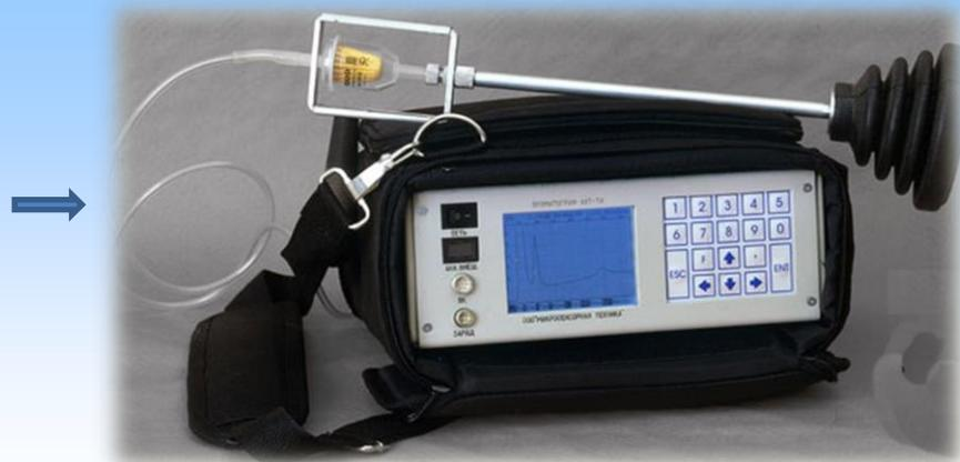
Газоанализатор «АНКАТ»–7631М для измерения массовой концентрации токсичных газов (СО);
